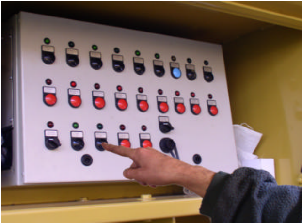
3:- Press button "Jaw adjust on"
